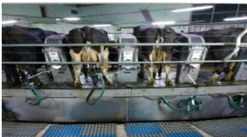
Рис.2.4. Електронне вимірювання кількості молока з індикацією на дисплеї блока-управління охолодження
