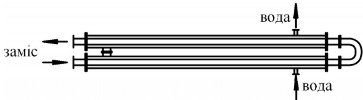
Рис.2.6. Теплообмінник для охолодження оцукреної маси типу «труба в трубі»
