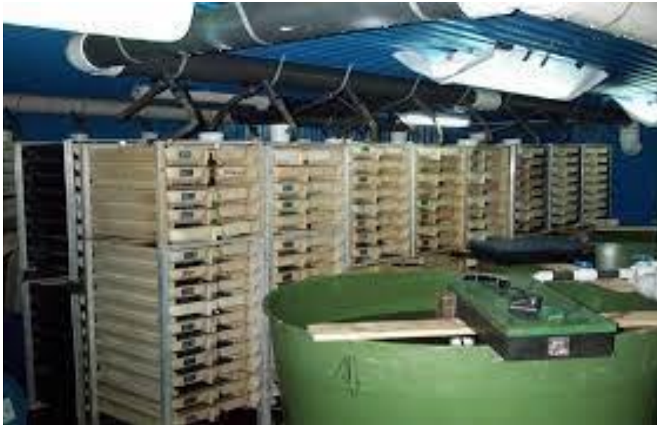
Рис. 6. Інкубаційний апарат горизонтального типу для відтворення лососевих видів риб
