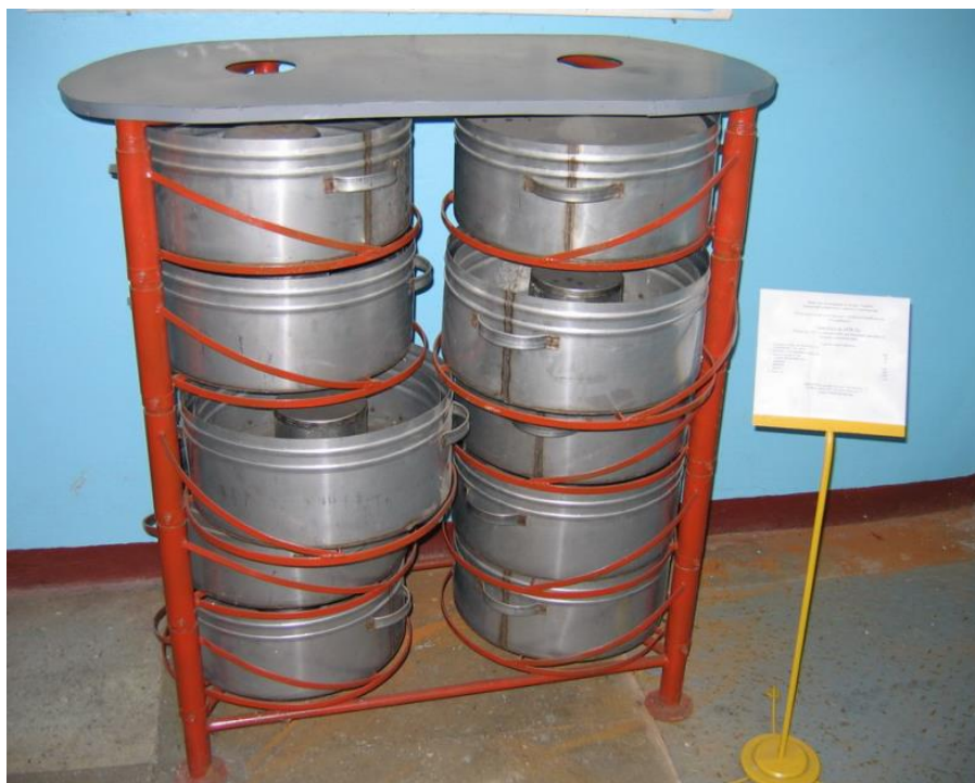
Рис. 5. – Інкубатор – «ІМ-2» для інкубації ікри форелі та інших лососевих риб в рибницьких форелевих господарствах та заводах ( https://tehribwod.at.ua/products/im2.png )
