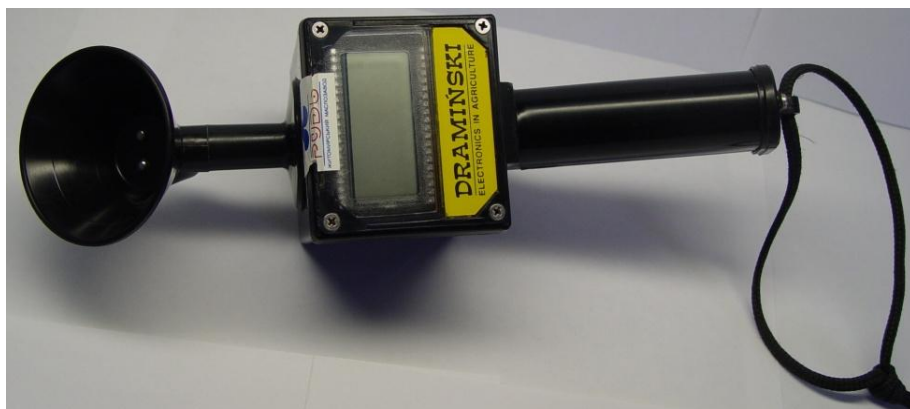
Рис. 2.1. Електронний визначник маститу від фірми „Драмінські”
