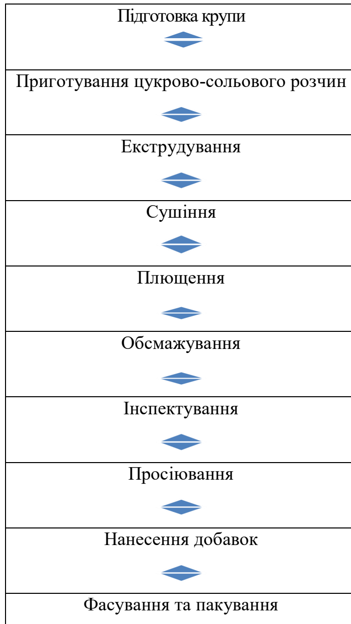
Рис. 3. Технологічна схема виробництва кукурудзяних пластівців
