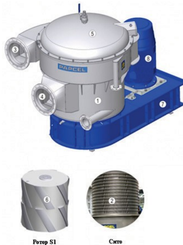
Рис. 12. Основні частини машини корпус сортування (1) із вертикальним циліндричним ситом (2) впускна (вхідна) частина (3) із сепаратором важких домішок; випускна (вихідна) частина (4) кришка (5); ротор (6) рама з ремінним приводом (7) електродвигун (8)
