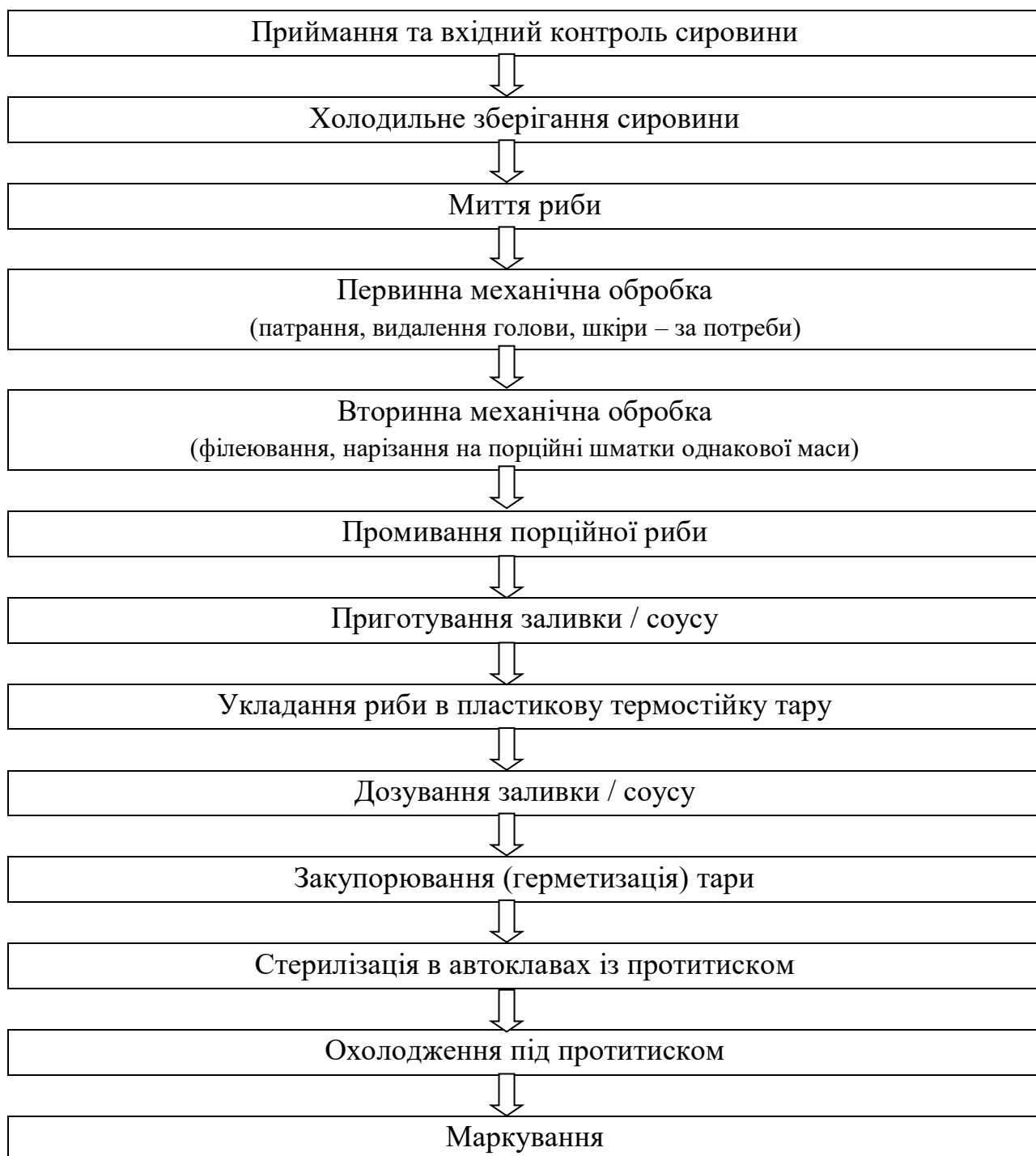
Рис. 1. Технологічна схема рибних пресервів
