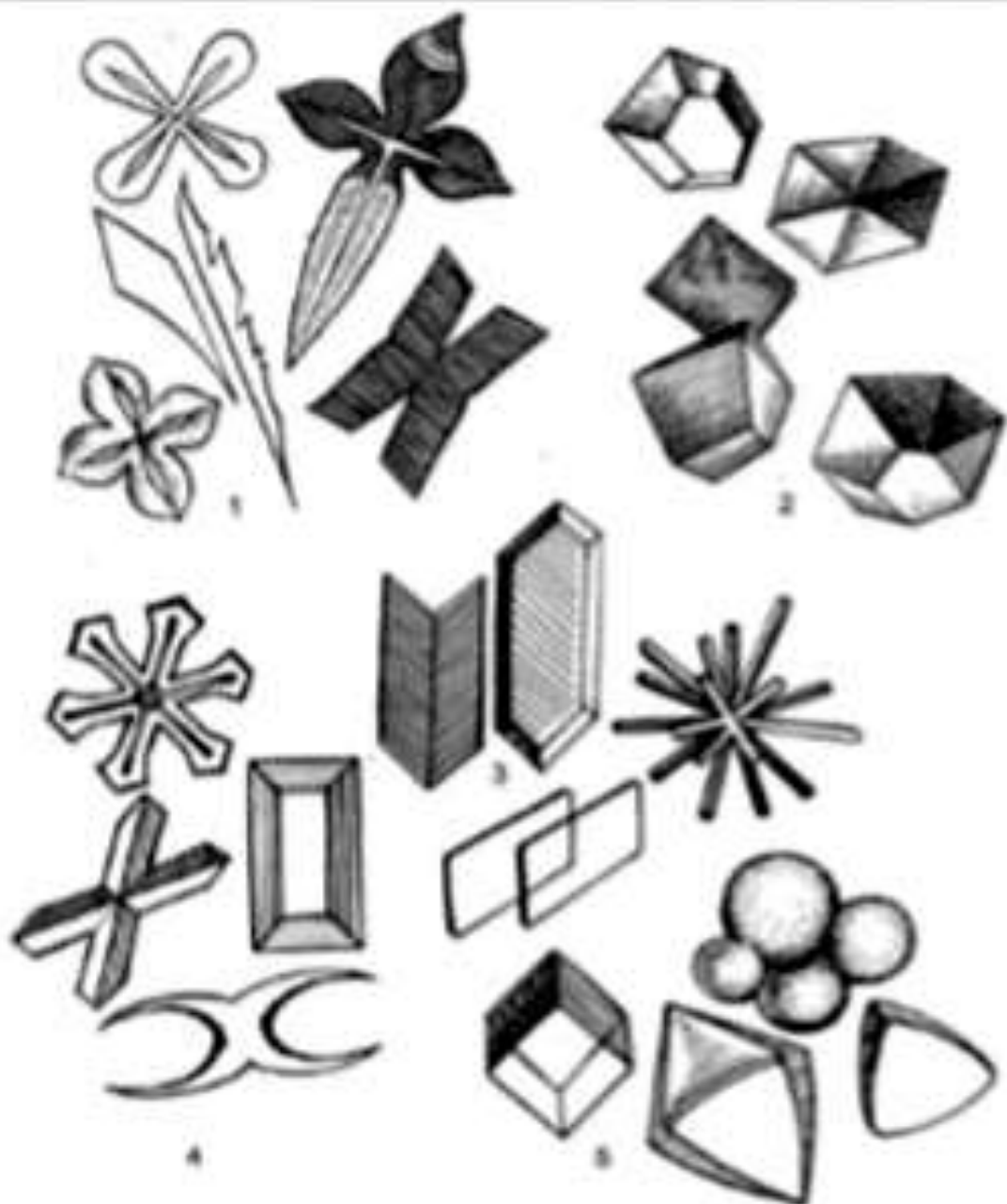
Рис. 5.1. Кристали (під мікроскопом): 1 – хлориду талію; 2 – свинцево-мідного нітрату калію; 3 – сульфату кальцію (гіпсу); 4 – фосфорно-аміачно-магnezіальної солі; 5 – фосфорномолібдату амонію.
