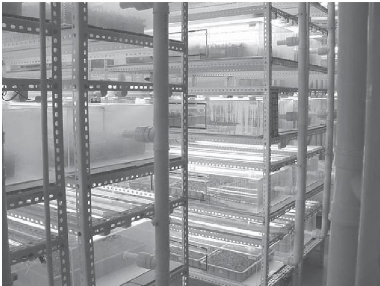
Рис. 25. Культуральна ємність (об'єм: 20 л) із системою примусової вентиляції та інтенсивного освітлення ФАМКР, розробленою Zobayed et al. (2000). Розміри: довжина 610 мм, ширина 310 мм і висота 105 мм.
