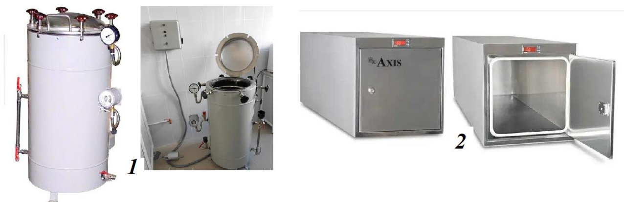
Рис. 30. Обладнання для стерилізації середовища та посуду, де: 1 - автоклав паровий ВК-75; 2 - стерилізатор етиленоксидний газовий
