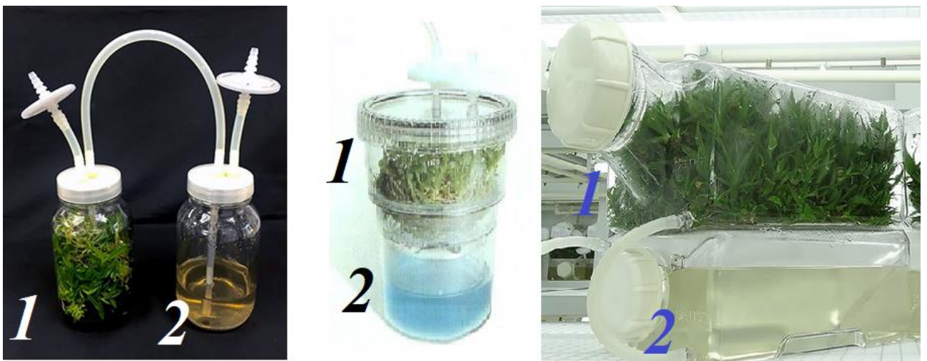
Рис. 22. Різні системи тимчасового занурення, де 1 - ємність з рослинними об'єктами; 2 - ємність для рідкого живильного середовища
