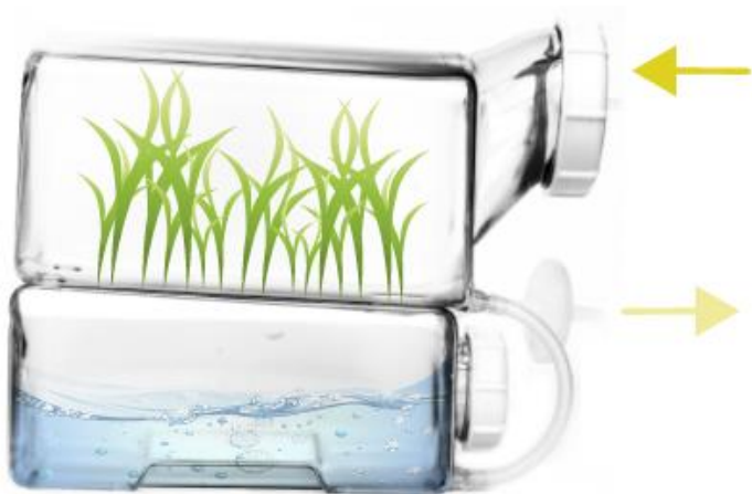
Рис. 24. Приклад роботи системи тимчасового занурення від SETIS™ ( https://setis-systems.be/home )
