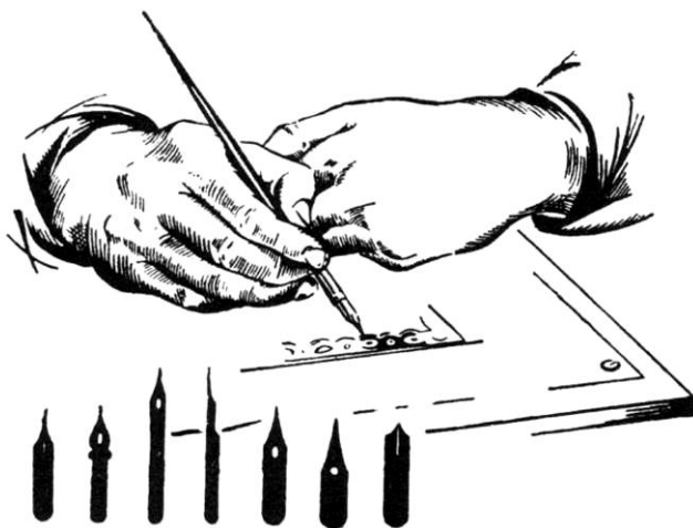
Рисунок 1.1.31 – Робота креслярським пером.
