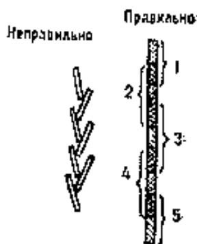
Рисунок 2.2.1 – Креслення ліній олівцем способом нарощування.
