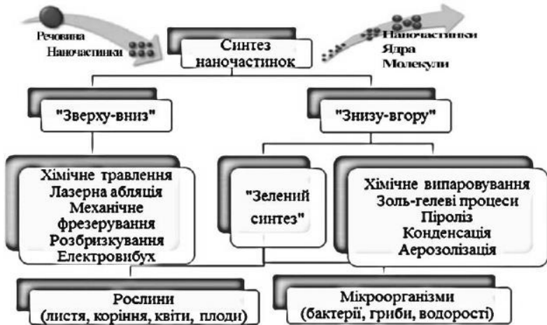
Рис. 1.2. Синтез наночастинок «зверху-вниз» і «знизу-вгору»
