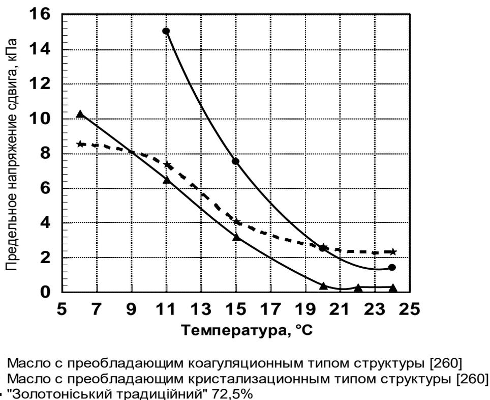
Рис. 4.4. Зависимость предельного напряжения сдвига образцов от температуры.
