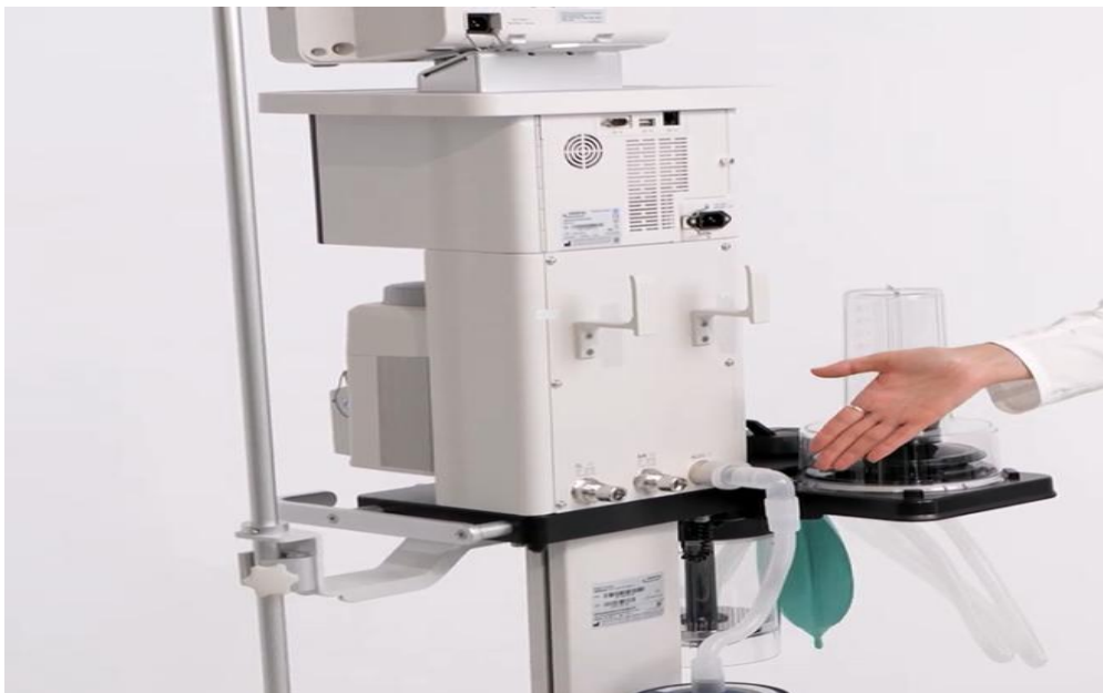
Рис. 2.2. Задня частина наркозо-дихального апарату Mindray Veta 5 має 3 роз'єми: подача кисню, подачу повітря та відпрацьованих газів.
