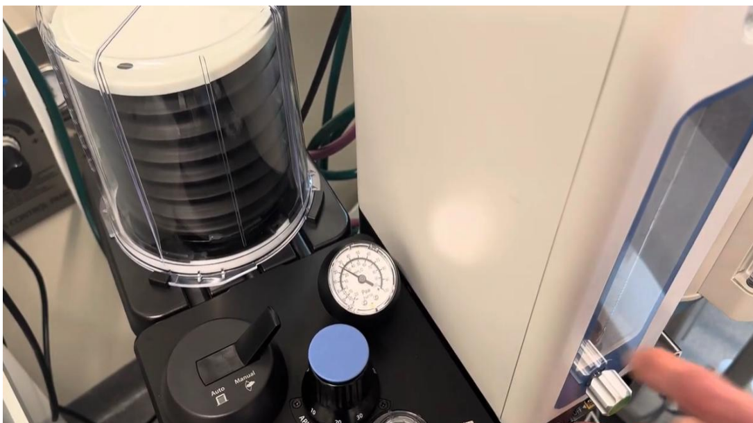
Рис. 2.10 Перевірка герметичності дихального мішка (близько 25 мм водяного стовпця)
