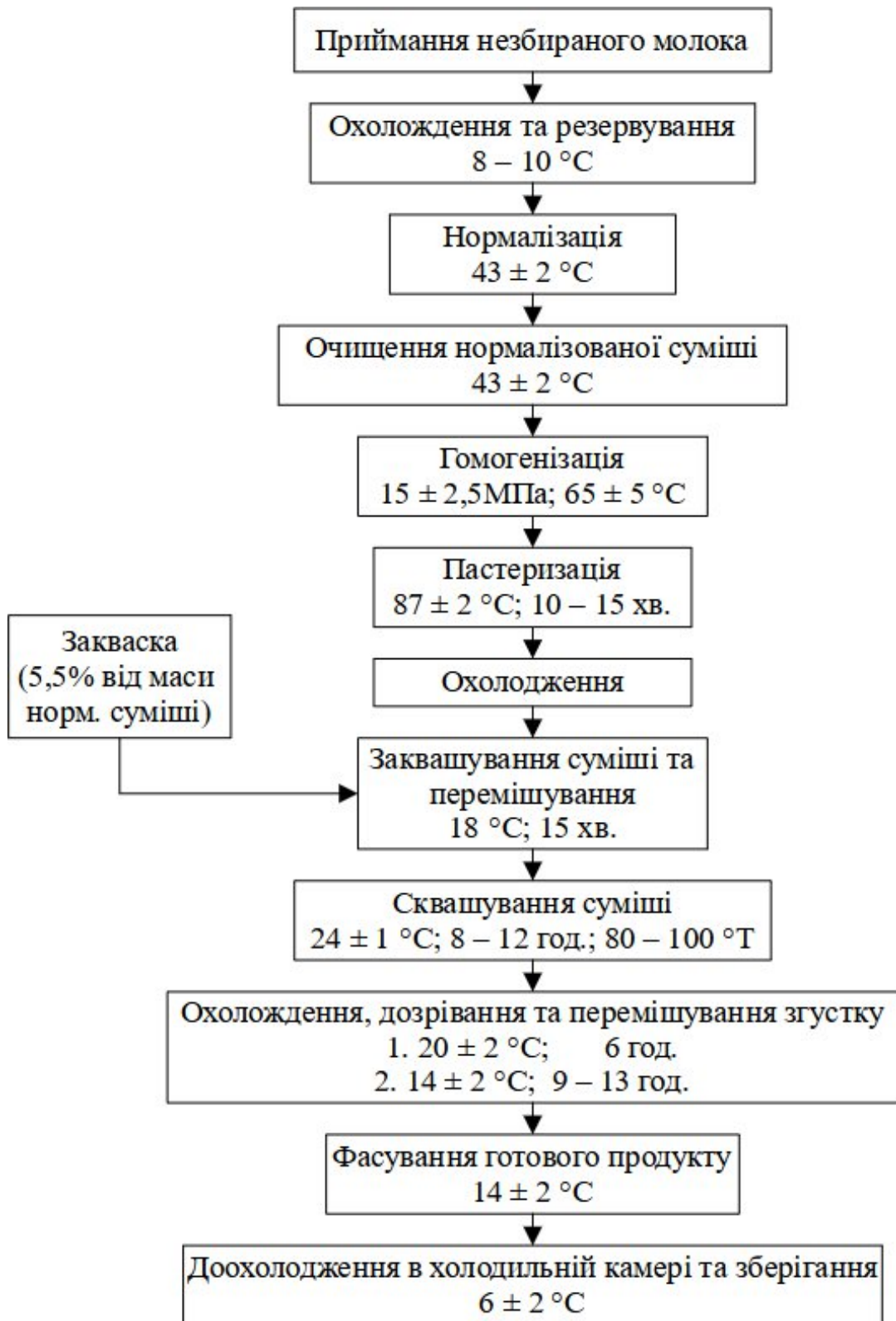
Рисунок 6. Блок-схема виробництва біфідокефіру
