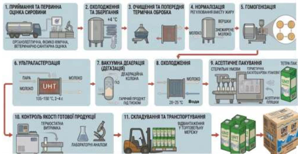
Рис. 3.3. Технологічна схема виробництва ультрапастеризованого молока
