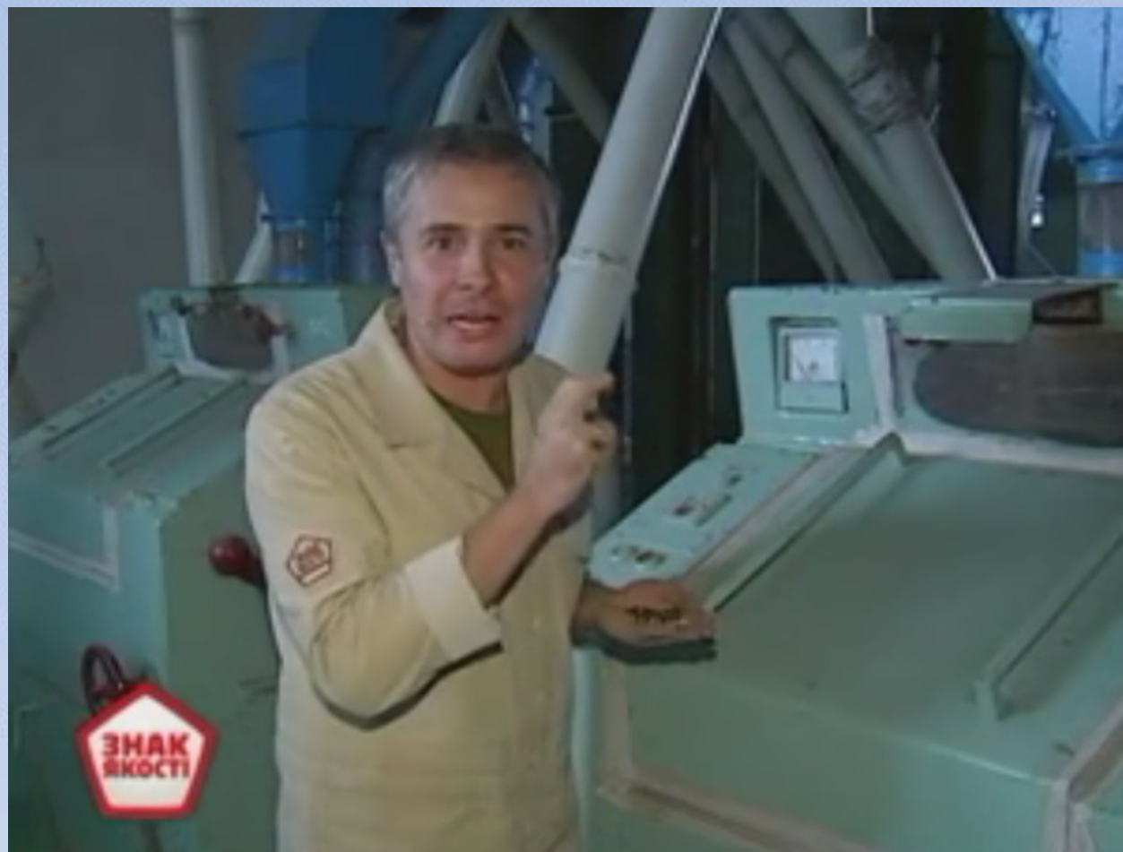
Лущення зерна і відокремлення ядра від плівок
