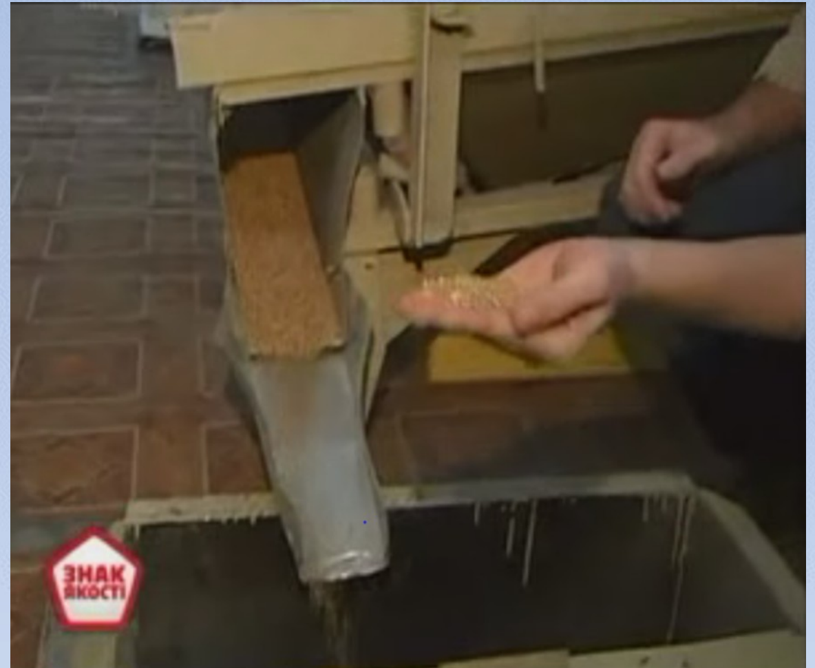
Остаточне очищення крупи на віброситах
