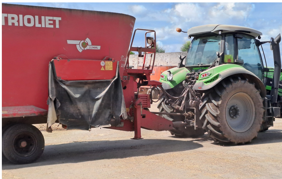
Рис. 4. Кормороздавач типу «Євроміксер»
