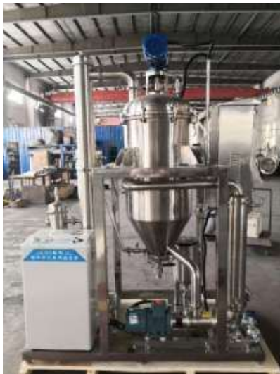
Рис. 11. Загальний вигляд та схема кристалізатору з рамною мішалкою: А – подача розчину, Б – відведення сокової пари, В – відведення кристалічної суспензії, Г – подача гострої пари, Д – відведення конденсату; 1 – корпус, 2 – сорочка обігрівальна парова, 3 – мішалка, 4 – привід мішалки
