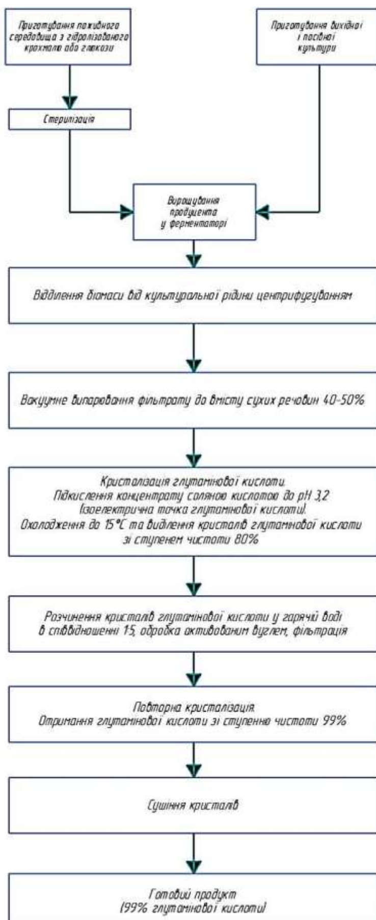
Рис. 5. Принципова схема отримання глутамінової кислоти
