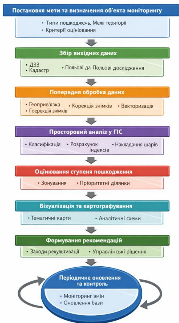
Рис. 1. Алгоритм моніторингу пошкоджених земель з використанням ГІС-технологій
