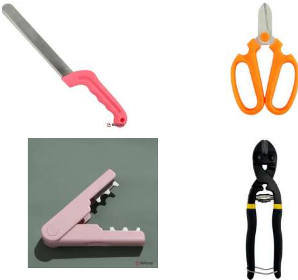
Рис. 3.6. Ріжучі інструменти, які використовуються у флористиці: ніж для флористичної піни; ножиці флористичні; шиподер; кусачки для дроту.
