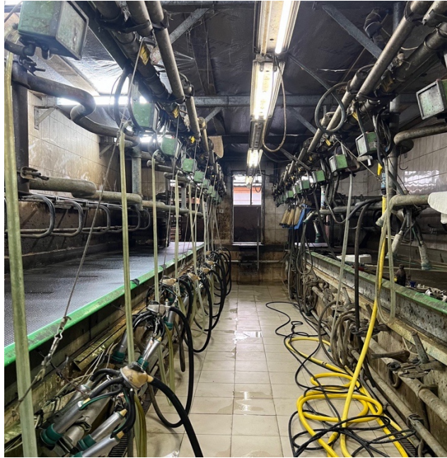
Рис. 3.7. Доїльний зал типу «ялинка» у ТОВ «Джет»
