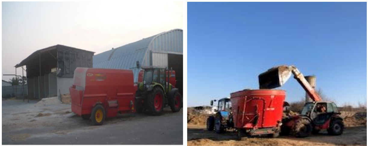
Рис. 3.7. Кормова станція та комплект машин для загрузки та роздавання корму.
