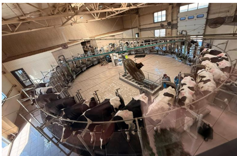
Рис. 3.4. Доїння корів на доїльному обладнанні типу «Карусель»
