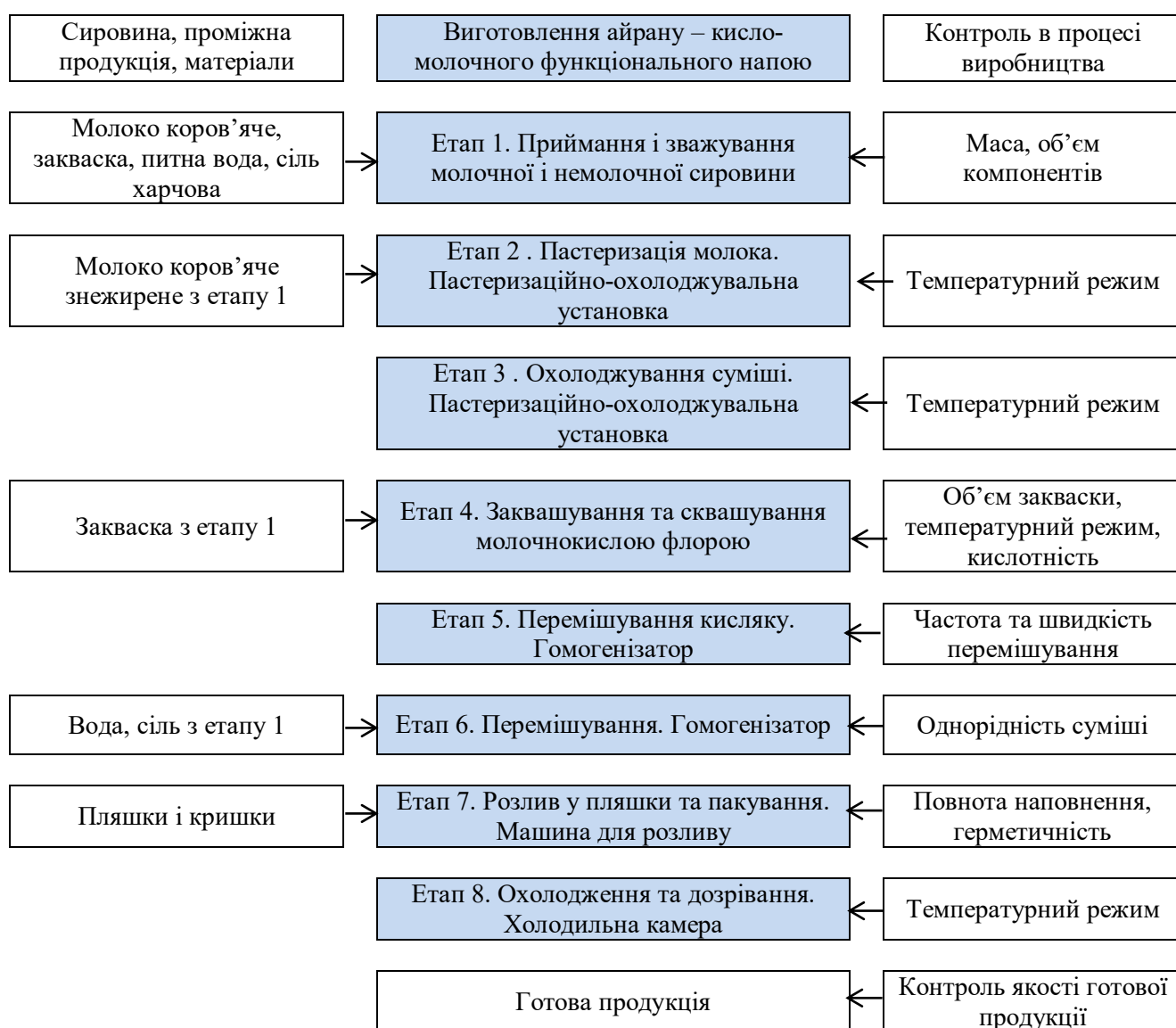
Рис. 3.8. Технологічна схема виробництва айрану
