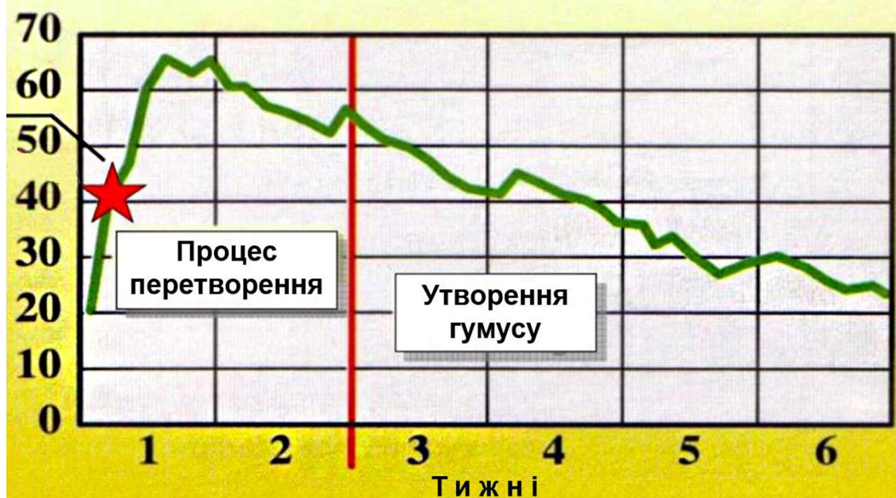
Рисунок 9. Схема зміни температури у компості за оптимальних умов створених при закладці бурта. Перші два тижні – температура піднімається, проходять аеробні процеси; наступний період проходить самоущільнення і аеробні процеси змінюються на анаеробні.
