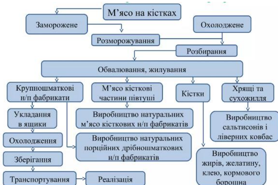
Рис. 3.5. Технологічна схема виготовлення натуральних напівфабрикатів
