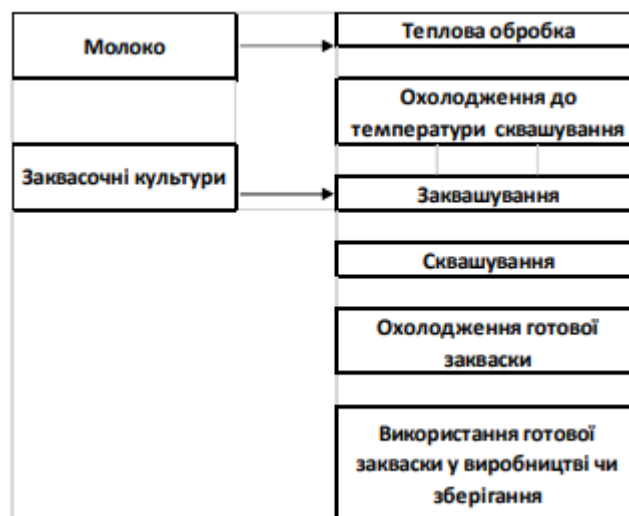
Рис. 3.8. Технологічна схема виробництва закваски
