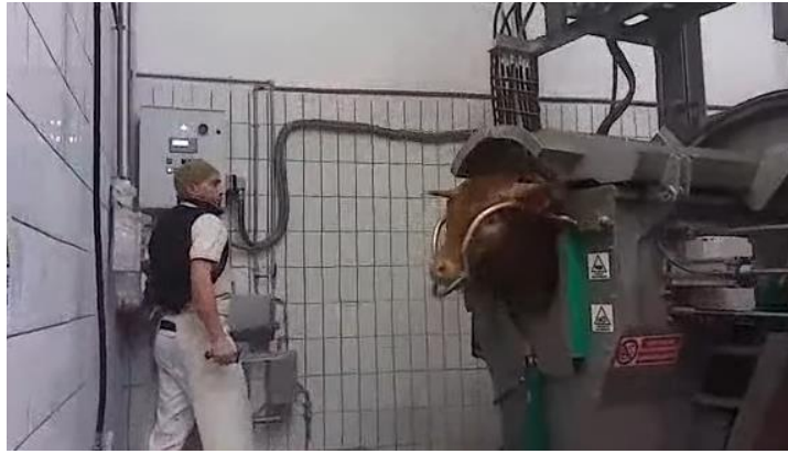
Рис. 3.11. Автоматична установка для забою тварин
