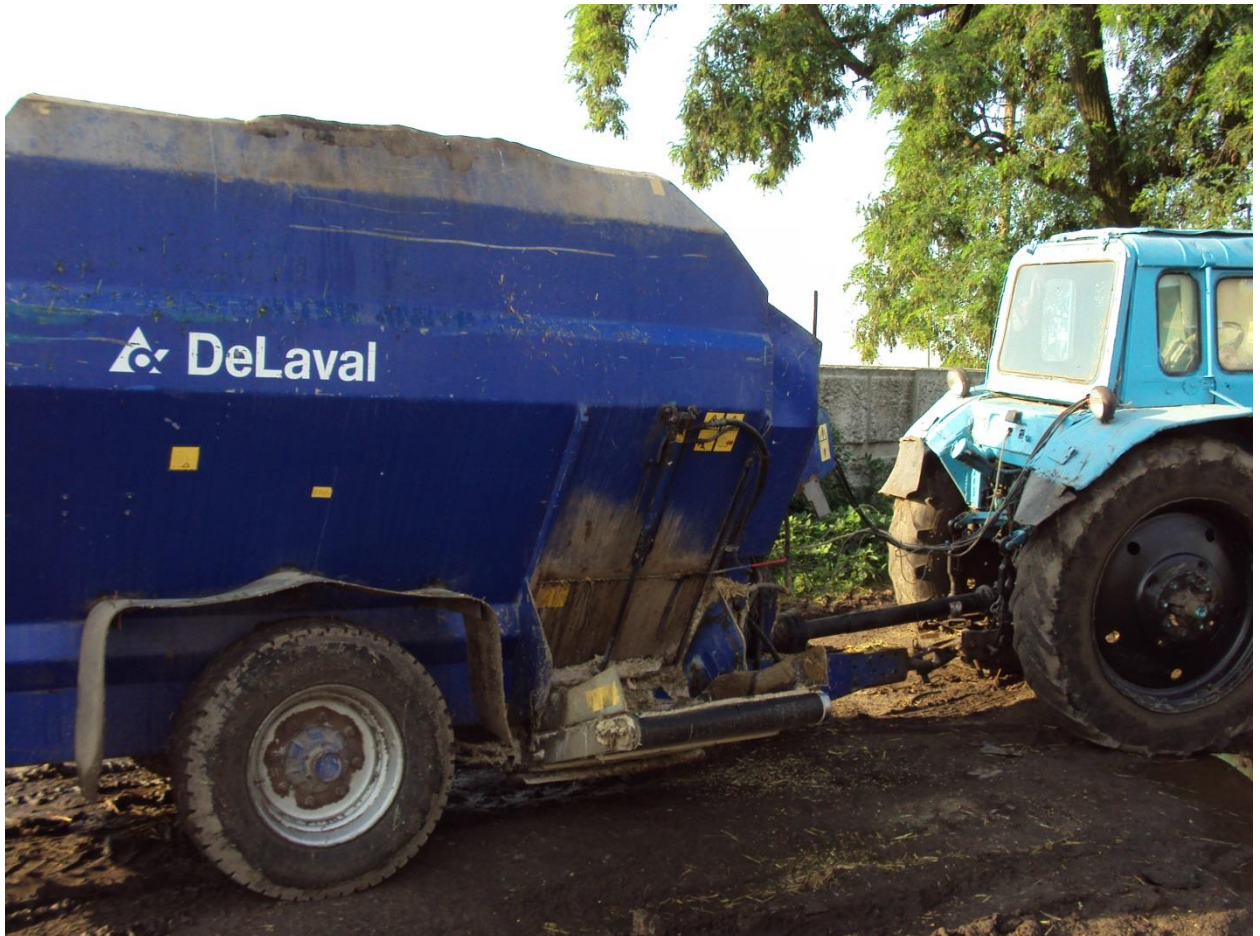
Рис. 6. Мобільний кормороздавач фірми DeLaval
