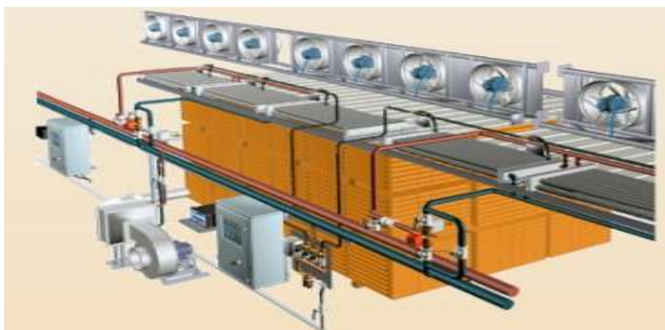
Рис. 6.4. Конвективна рециркуляційна сушка
