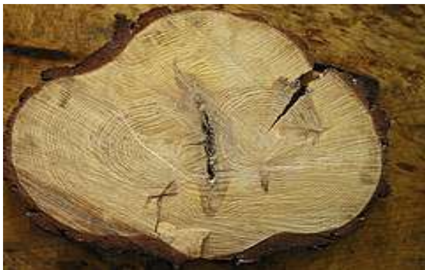
Рис. 4.25. Подвійна серцевина, рийки на поверхні і прорість усередині
