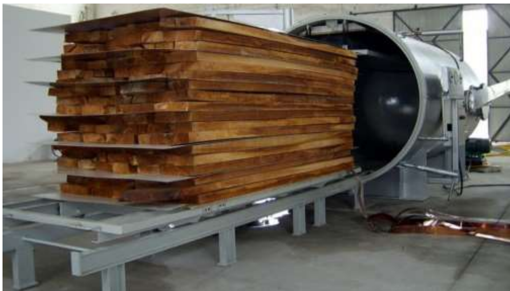
Рис. 6.7. Сушіння деревини за допомогою обладнання Trotec
