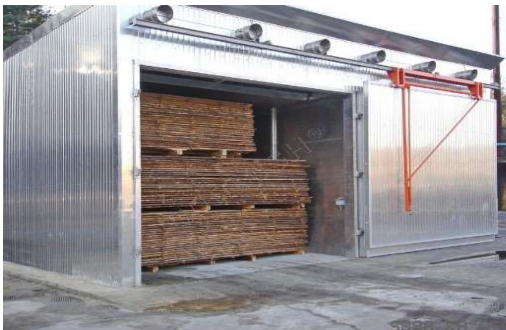
Рис. 6.2. Штучне сушіння деревини
