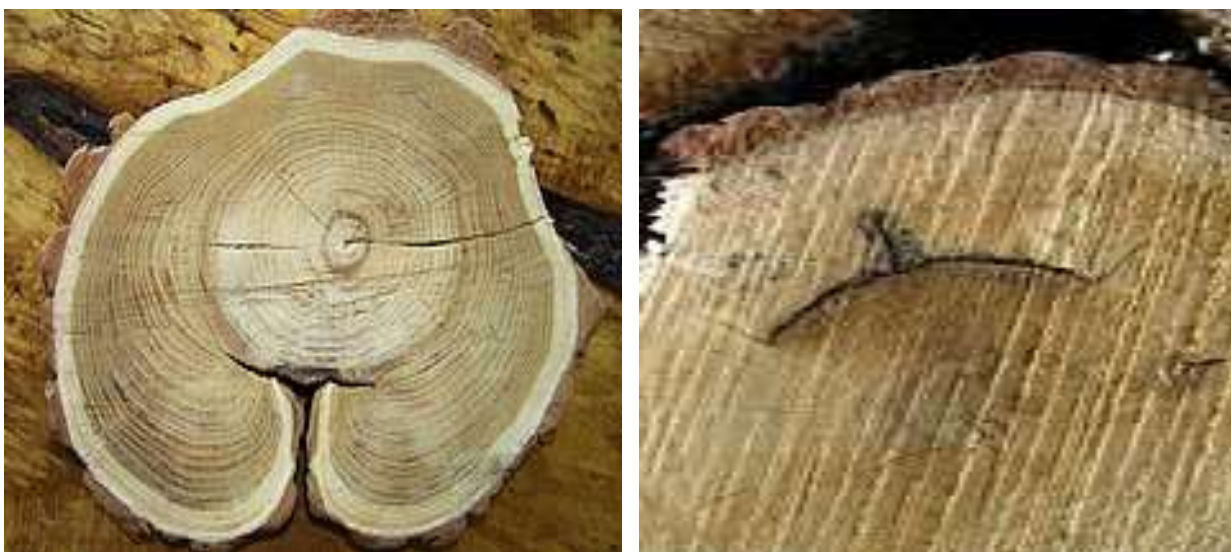
Рис. 4.27. Відкрита та закрита прорість на торці пиломатеріалу
