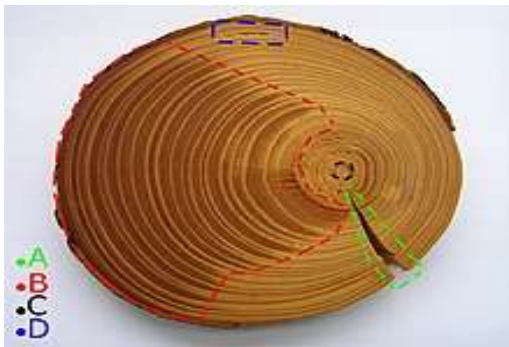
Рис. 4.19. А – розхідна тріщина усушки, В – суцільний крен, С – зміщена серцевина, D – смоляна кишенька
