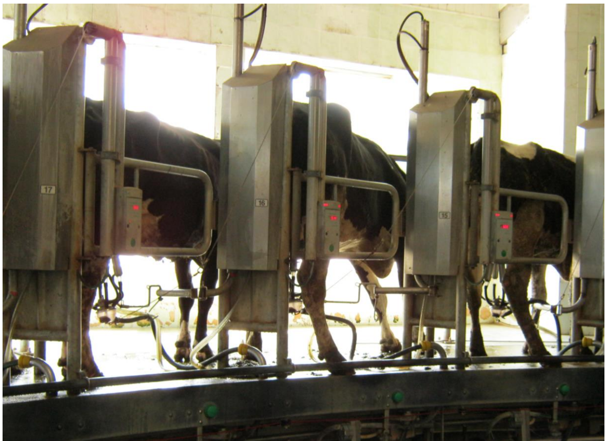
Мал. 8. – Комп'ютерний облік надою за допомогою електронних пристроїв – метатронів, встановлених біля кожного доїльного місця
