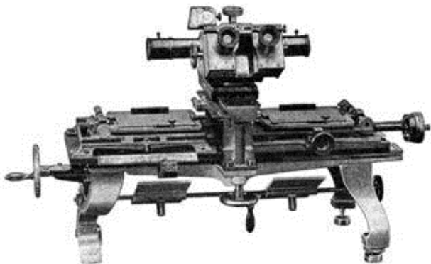
Рис. 1.28. Топографічний стереометр Дробишева (СТД).
