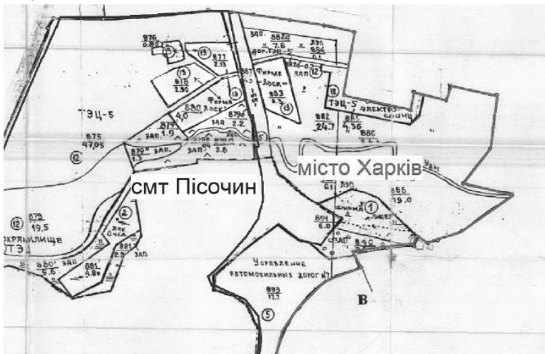
Рисунок 2.5. Приклад накладання меж згідно проекту встановлення меж населеного пункту на межу міста Харків, зареєстровану в ДЗК
