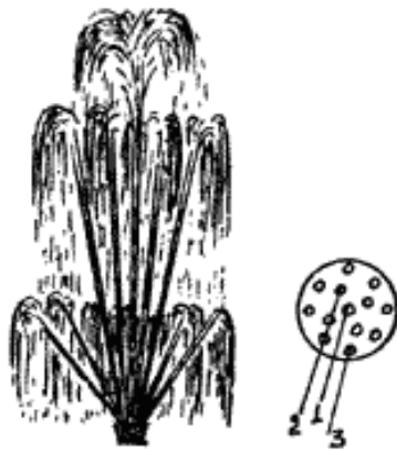
Рис. 3.24. Фонтан і насадка - «ярусний розпилювач»; 1 - великий напір; 2 - середній напір; 3 - малий напір;
