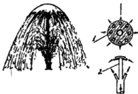
Рис. 3.19. Фонтан і насадка «тіффані»; 1 - вид насадки зверху; 2 - вид насадки збоку
