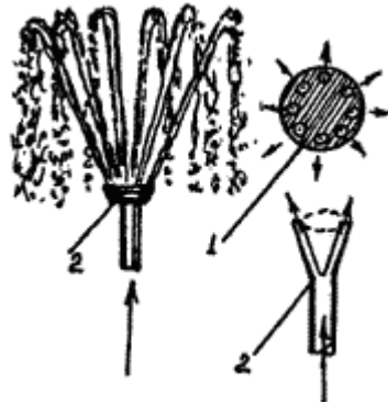
Рис. 3.21. Фонтан і насадка «риб'ячий хвіст»; 1 - вид насадки зверху; 2 - вид насадки збоку.
