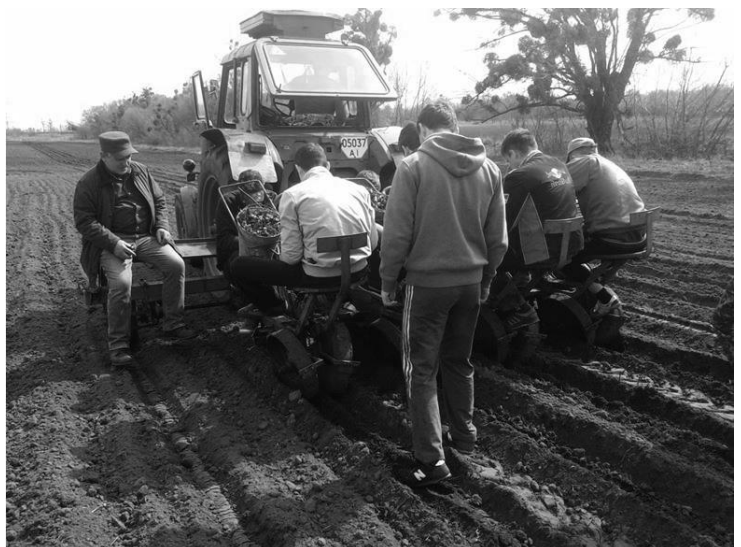
Асистент В.А. Демещук з студентами випробовують модернізовану секцію розсадосадильної машини СКН-6А для садіння ризом міскантусу
