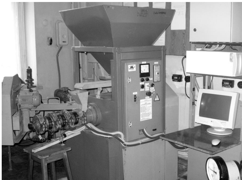
Рис. 2. Екструдер зерновий ЕЗ-150
