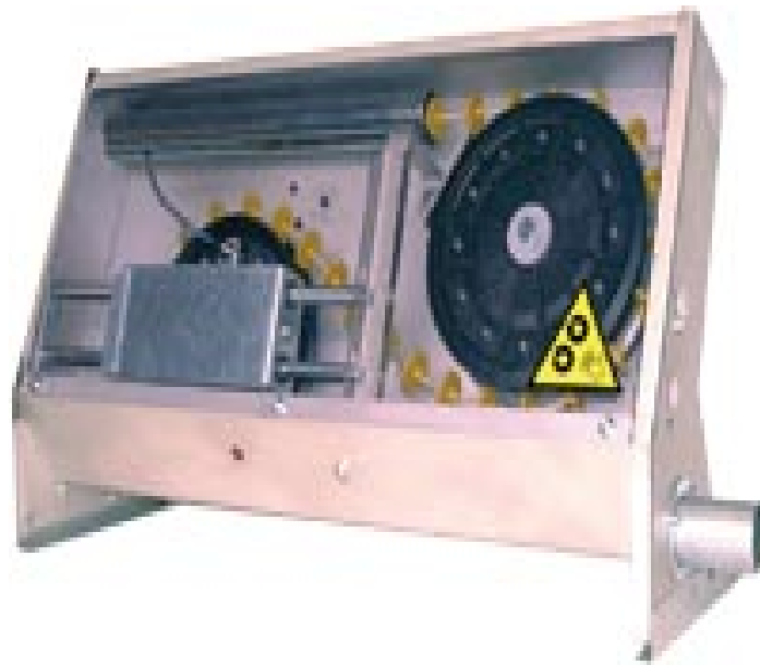
Рис. 4.3.25 – Запатентований приводний механізм для подачі корму тросо-шайбовим транспортером
