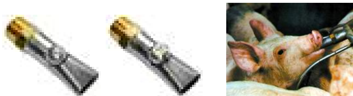
Рис.4.3.49 – Соскові клапани для рідкої годівлі з кусальною кулькою для менших втрат води
