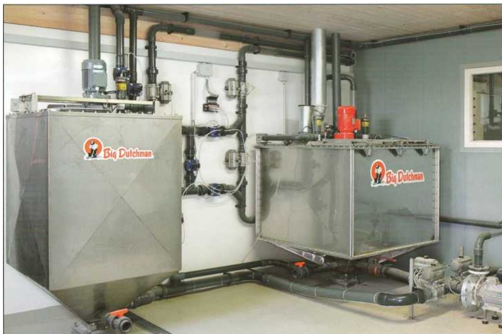
Рис. 4.3.40 – Кормокухня з використанням системи «HydroMix» станкового обладнання. Кормовий комп'ютер здійснює управління всієї установки.
