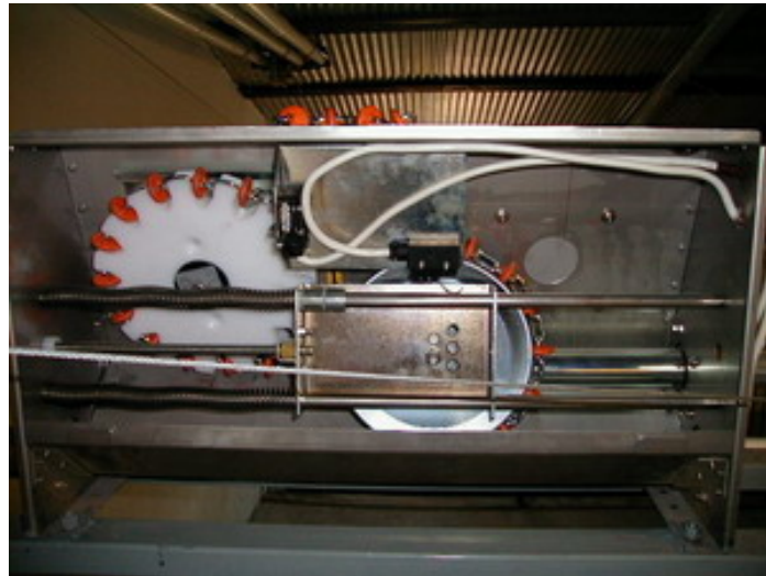
Рис. 4.3.23 – Привідний механізм, що приводить у рух трос, ланцюг або спіраль
