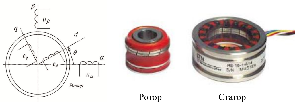
Рис. 2.48. Схема і будова резольвера
