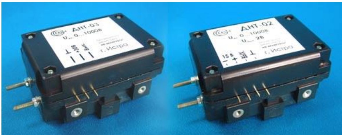
Рис. 2.35. Датчики змінної напруги на основі ефекту Холла серії ДНТ
