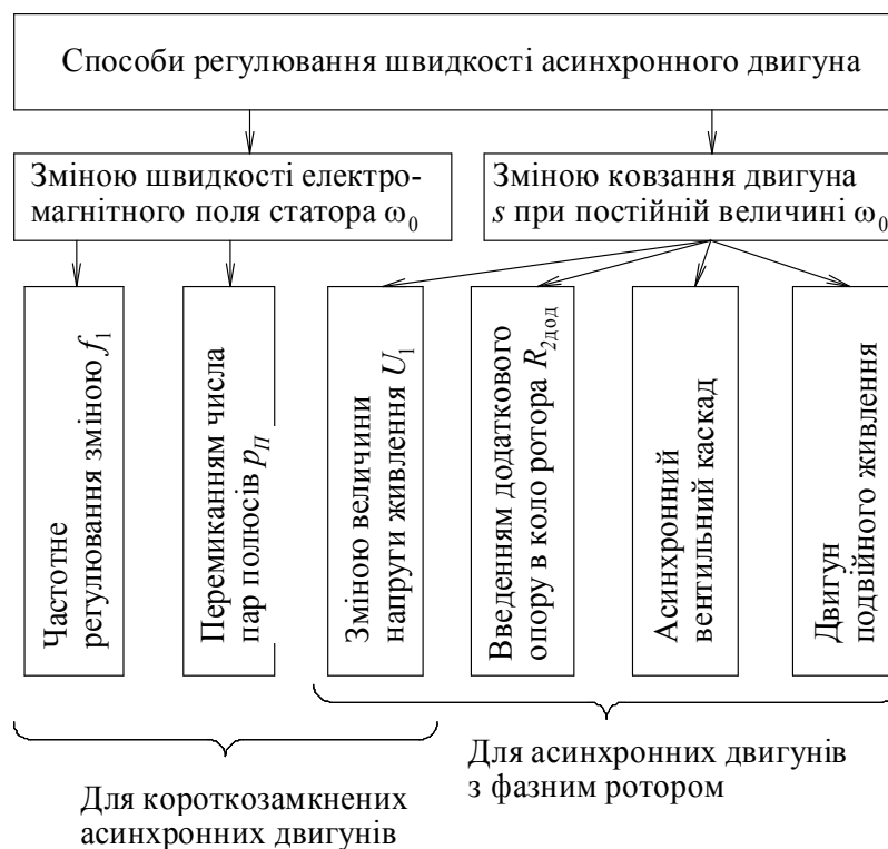
Рис. 5.9. Класифікація способів регулювання асинхронних двигунів
