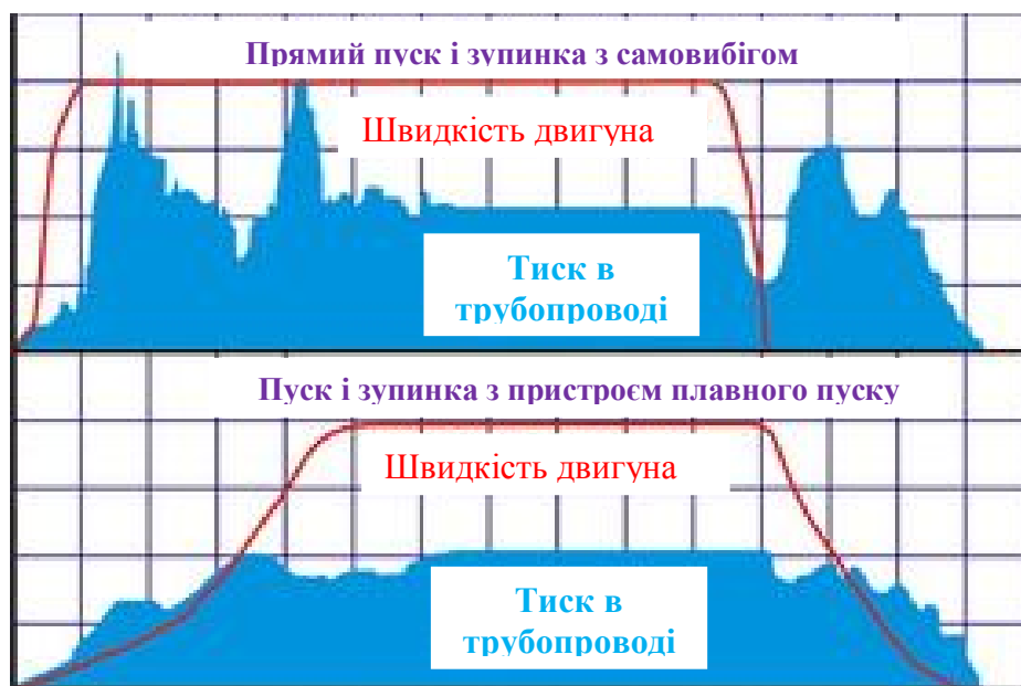
Рис. 5.15. Діаграми швидкості та тиску в трубопроводах при пуску і зупинці двигуна відцентрового насоса
