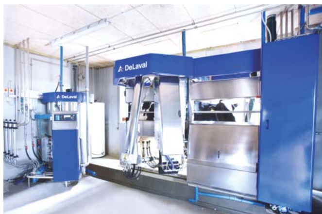
Рис. 2 – Роботизована доїльна установка фірми «De-Laval»
