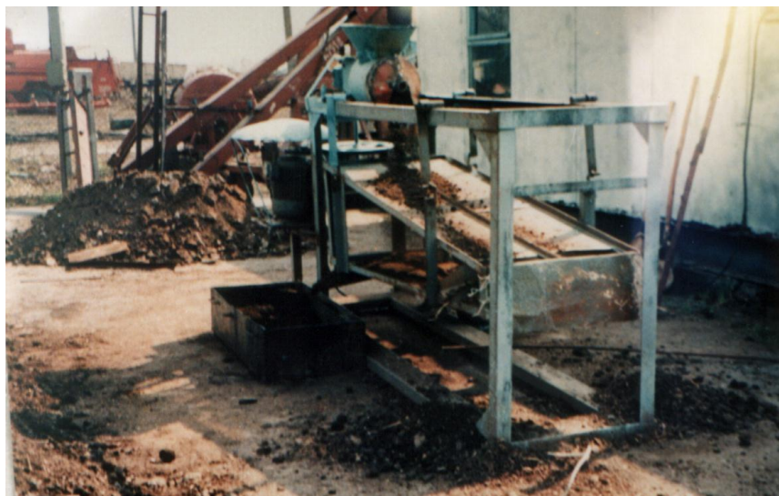
Рис. 9.20. Загальний вигляд установки для подрібнення і фракціонування біогумусу.
