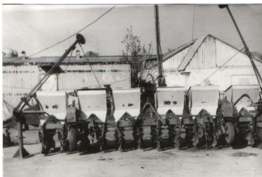
Рис. 9.21. Загальний вигляд бурякової сівалки ССТ-12А з туковисіваючими апаратами для локального внесення біогумусу.
