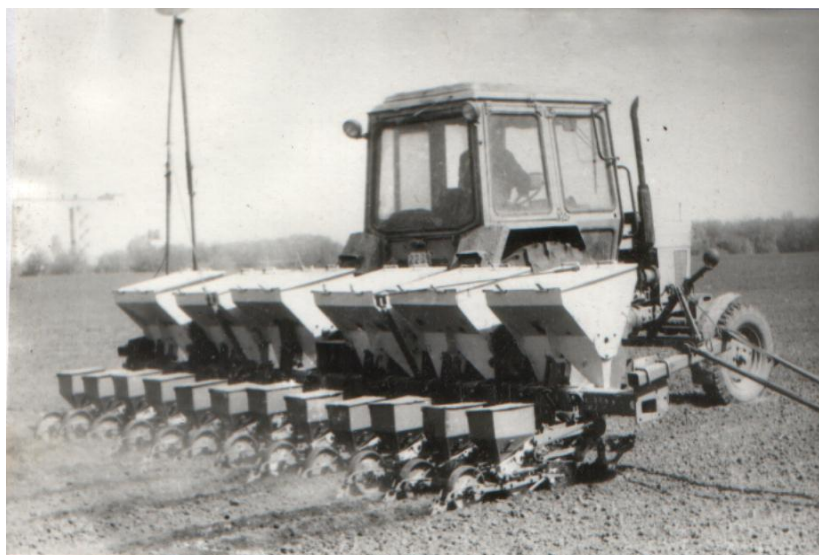
Рис. 9.22. Агрегат для посіву цукрових буряків з одночасним внесенням товарного біогумусу в роботі.
