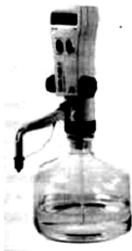
Рис. 1.9. Електронний дозатор з мікропроцесорною клавіатурою
