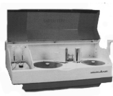
Рис. 1.3. Автоматичний біохімічний аналізатор крові
