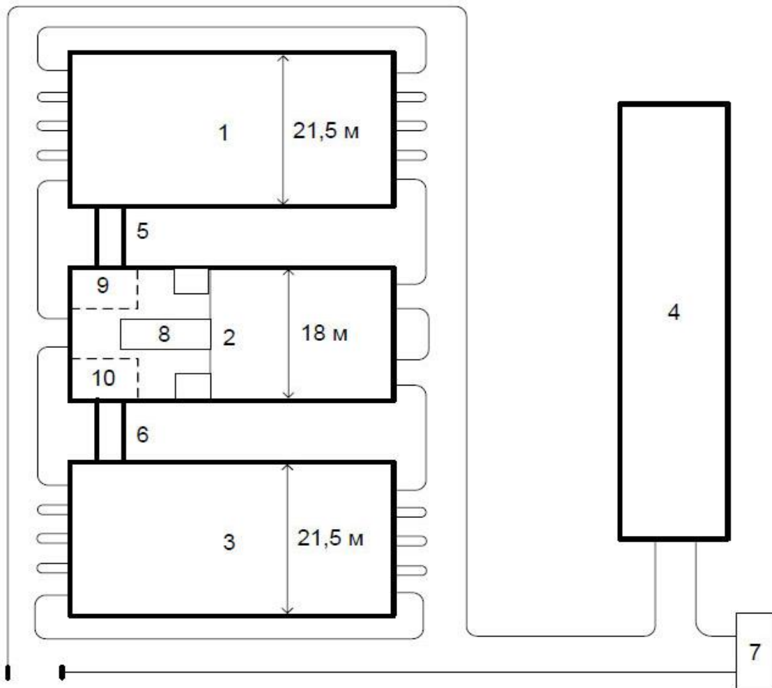
Рис. 2.1.1.2. Загальний план розміщення молочного комплексу на 180 корів з утриманням у боксах, видаленням гною мобільним засобом і доїнням у доїльно-молочному блоці (компонування на складному рельєфі місцевості і обмеженні місця під будівництво) з подальшою переробкою молока (виготовлення сиру).
