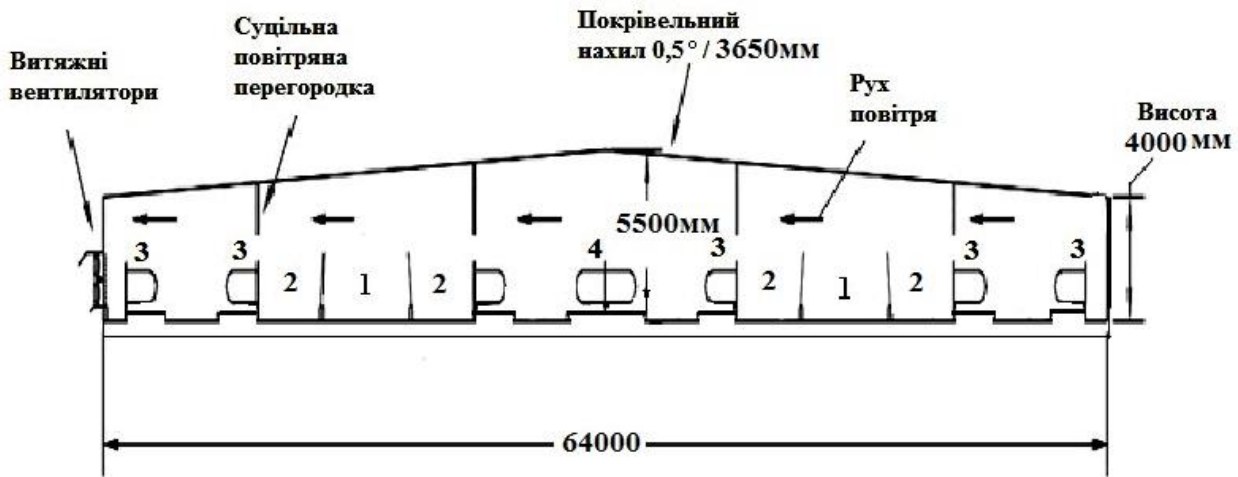
Рис. 2.1.3.1. Фронтальний розріз восьмирядного корівника типу LPCV на 800 корів (J. P. Harner, J. F. Swith, 2008).
