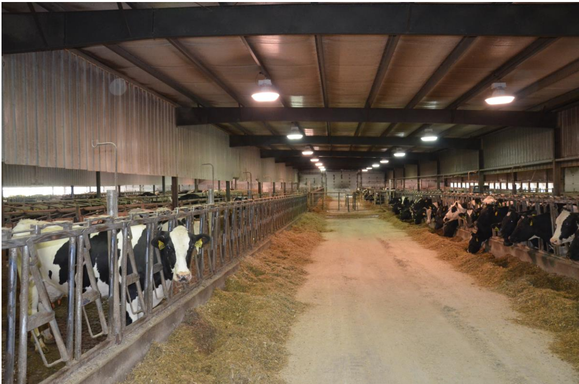
Рис. 2.1.3.5. Видяг корівника зі сторони кормового проїзду. Освітлення за допомогою Лед лампи (LED – light emitting diode), (над обмежувальною планкою хедлоків висять повітряні перегородки).
