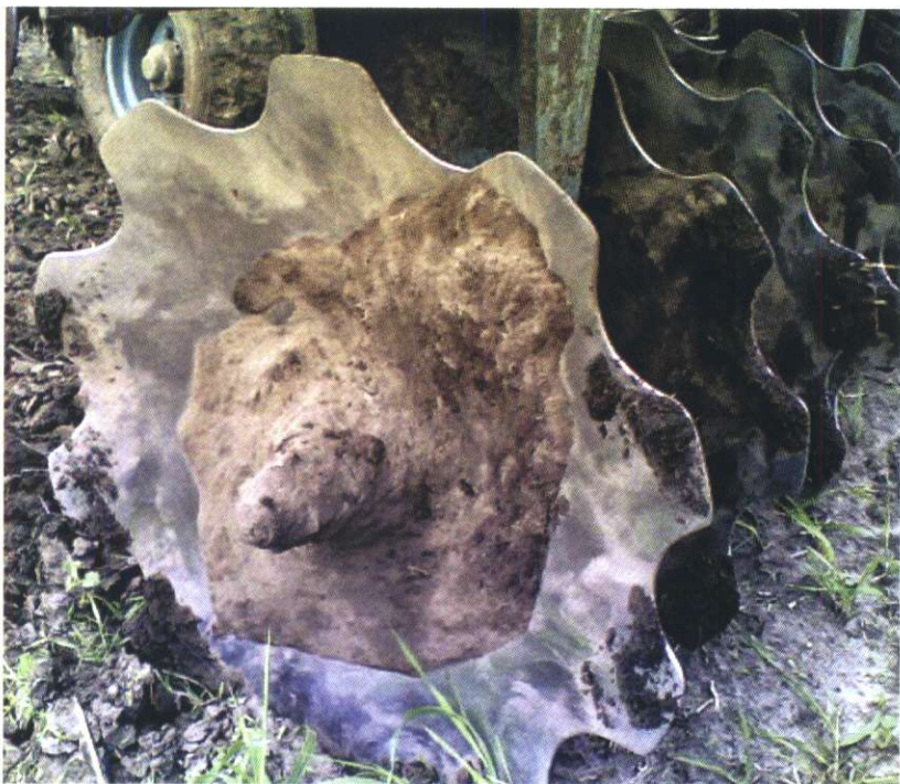
Налипання ґрунту підвищеної вологості на дисковий робочий орган борони БДТ-7
