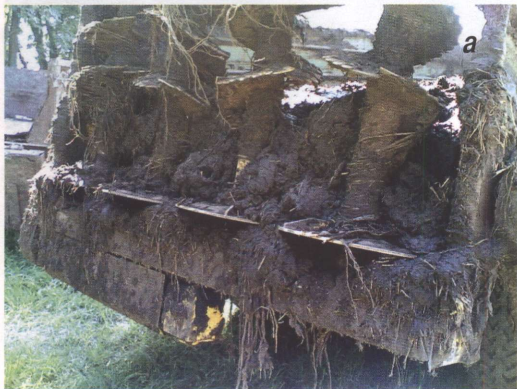
В'язальний шпагат, намотаний на бітери (а), знижує продуктивність розкидача, а потрапляння твердих включень на робочі органи (б) виводить його із ладу
