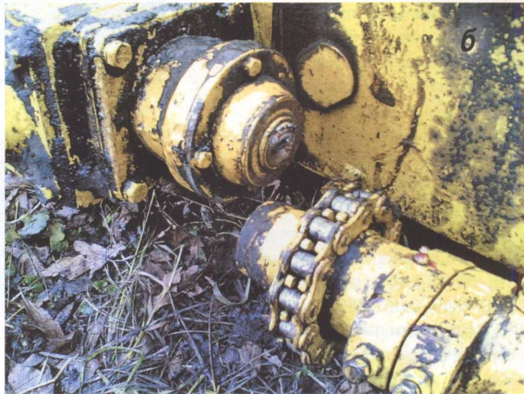
В'язальний шпагат, намотаний на бітери (а), знижує продуктивність розкидача, а потрапляння твердих включень на робочі органи (б) виводить його із ладу
