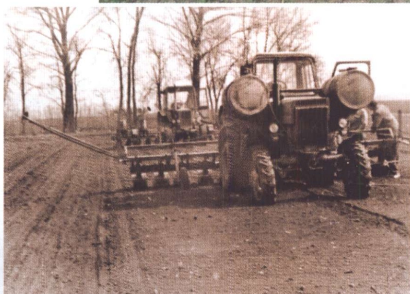
Уперше смугове внесення було застосовано у далекому 1986 році: використовуючи агрегат у складі монтованого обприскувача ПОМ-630 та вдосконаленого фрезерного культиватора КФ-5,4, вносили гербіциди у зону рядка на глибину загортання насіння, що дало змогу досягти максимальної ефективності їхньої дії. Після цього посівний агрегат (на фото — бурякова сівалка ССТ-12Б) висівав насіння в оброблену зону
