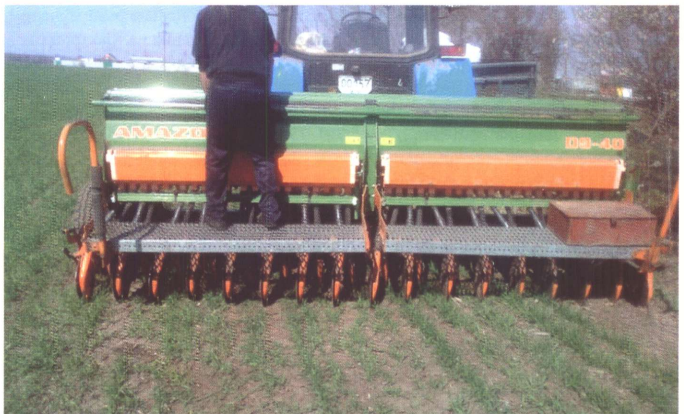
Використання однопрохідного підживлення дасть змогу адресно доставити всі добрива у рядок і загорнути їх ґрунтом
