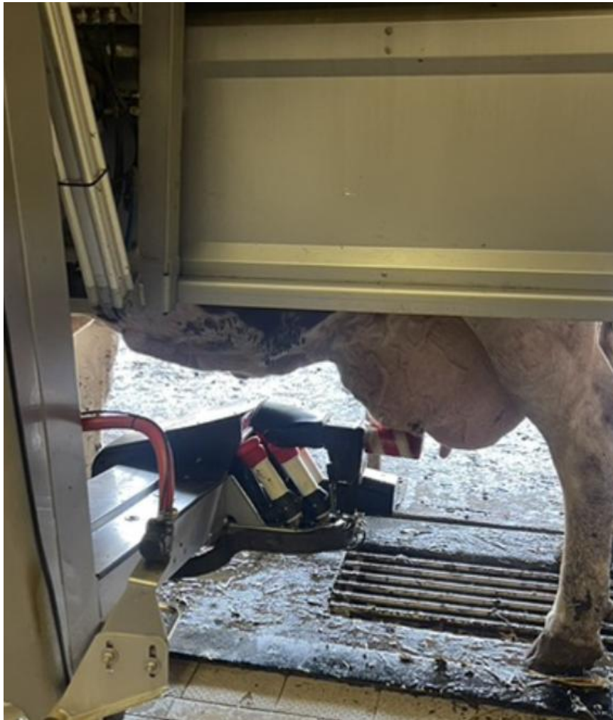
Рисунок 2.5 – Система пошуку дійок із використанням лазерних датчиків у роботизованій доїльній установці
