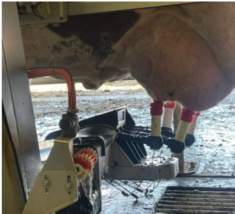
Рисунок 2.4 – Процес доїння корів за допомогою роботизованої системи DeLaval
