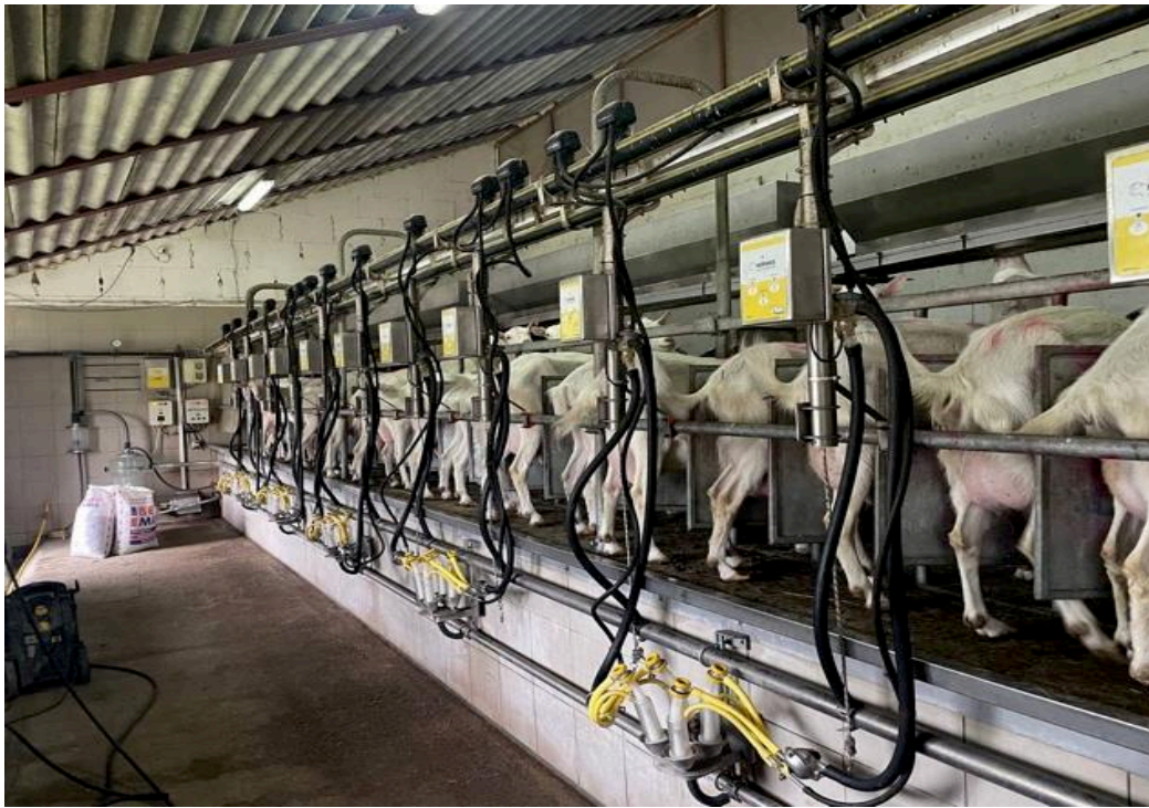
Рис. 2.4. Автоматизоване доїння кіз на доїльній установці HERMES ARS system
