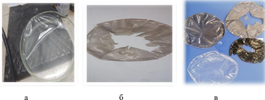
Рис.1. Плівки ПЕВТ до (а) та після (б, в) УФ –опромінення.
