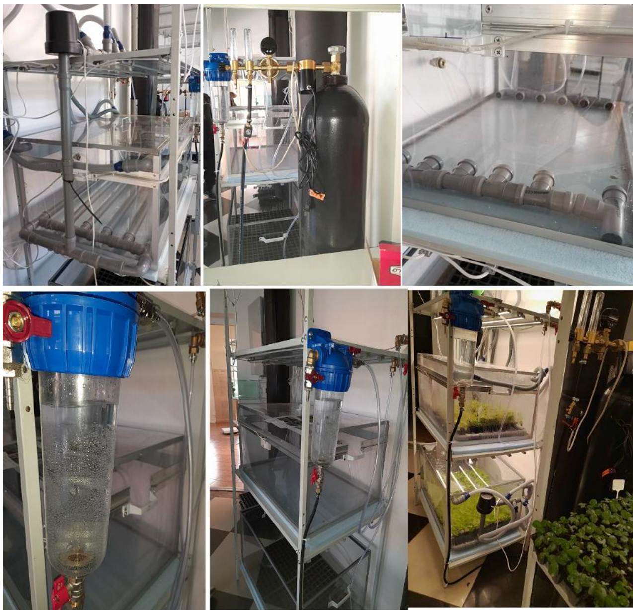
Рис. 2.6. Особливості будови біореактора
