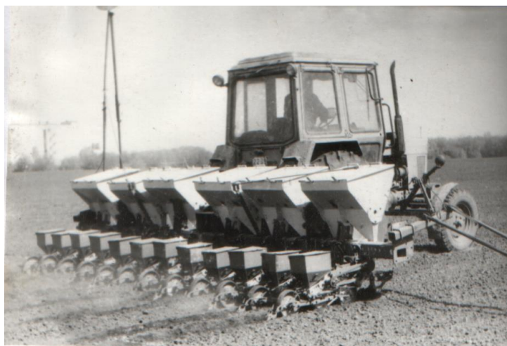
Рис. 1. Агрегат для посіву цукрових буряків з одночасним локальним внесенням товарного біогумусу в роботі.
