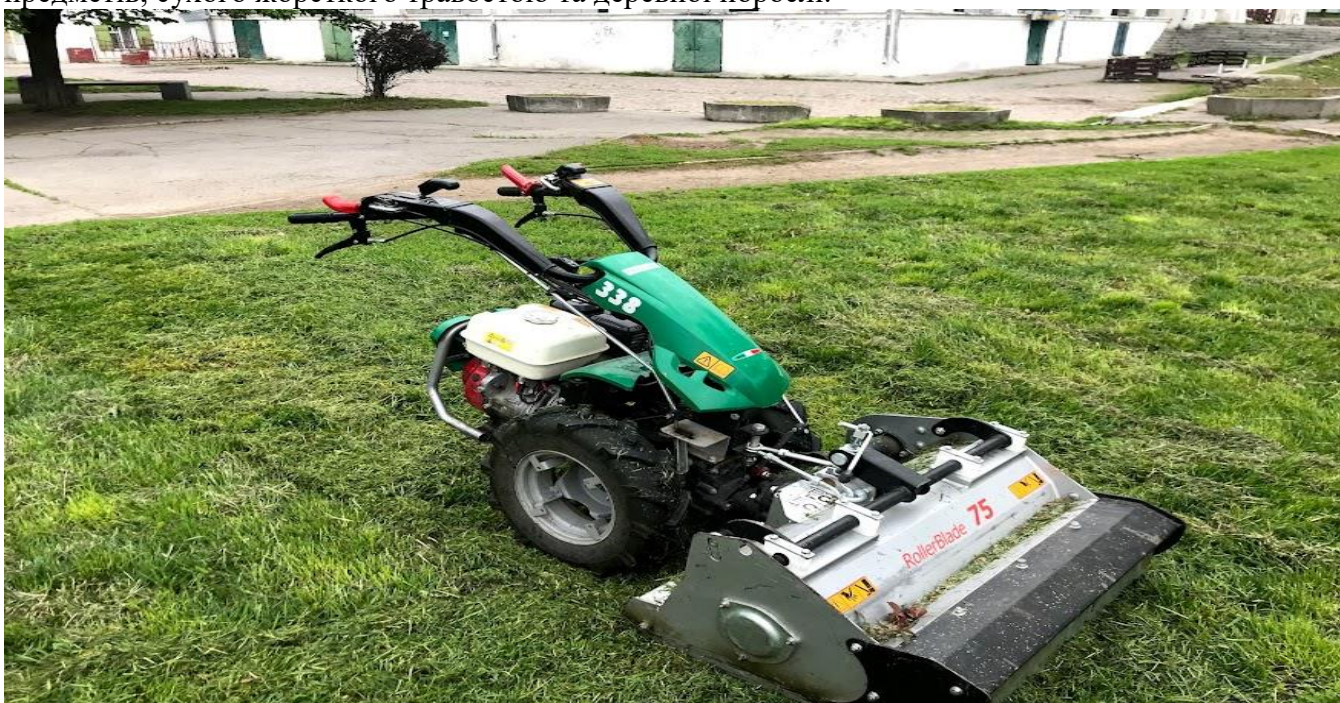
Рис.3.6 автоматичний блок «Ferrari» з насадкою газонокосарки барабанного типу, був обраний для вирішення задач з покосів у зв'язку з великим вмістом сторонніх предметів на поверхнях газонного покриття.
