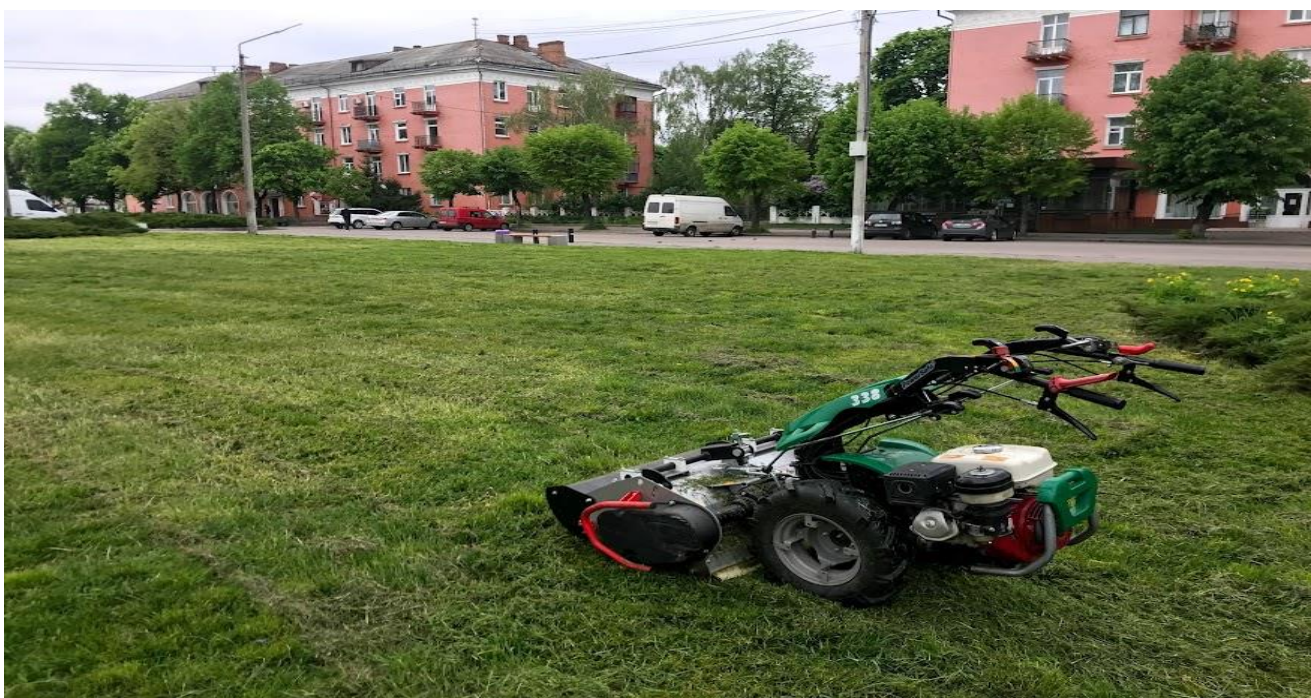
Рис.3.5 На фото самохідний автоматичний блок «Ferrari» з насадкою газонокосарки барабанного типу, що дозволяє обслуговувати покосами складні газони з великим вмістом сторонніх предметів, сухого жорсткого травостою та деревної порослі.
