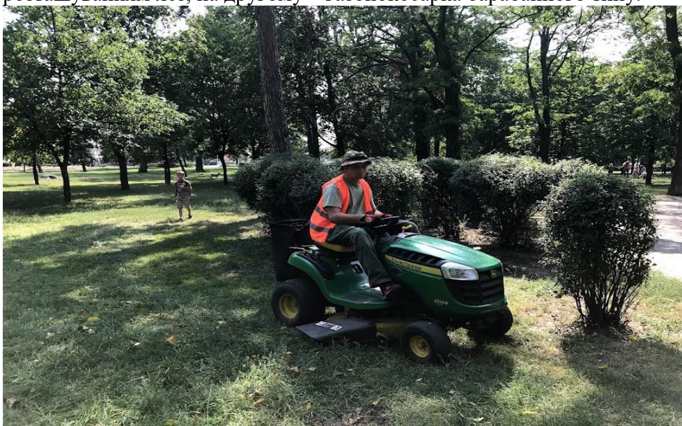
Рис.3.9 Спеціалізований трактор «John Deere» під час виконання покосу на території об'єкту одночасно виконує функцію мульчування залишками скошених газонних трав подрібнених до стану крупного пилю.
