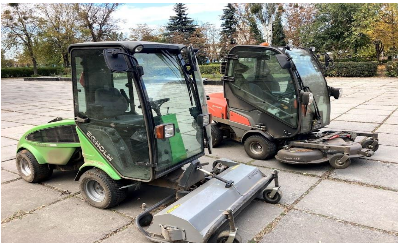
Рис.3.8 На фото дві мультисистеми призначені для обслуговування міського простору, в тому числі і газонного покриття, якими здійснювалось обслуговування даного об'єкту озеленення: «Husqvarna» та «Egholm» з різними насадками для покосу: – зі стандартним горизонтальним розташуванням лез, на другому – газонокосарка барабанного типу.
