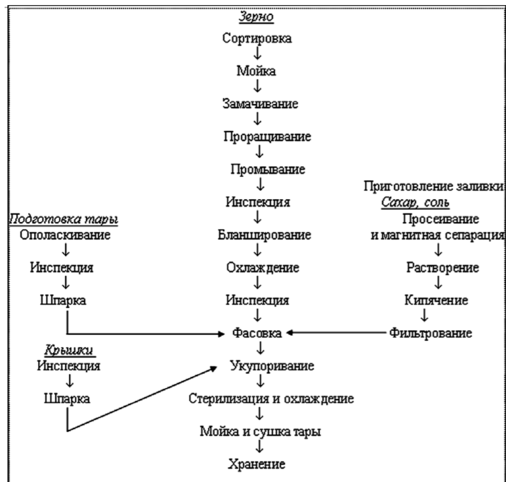
Рис. 3. Технологическая схема производства консервированных продуктов из пророщенного зерна пшеницы и тритикале
